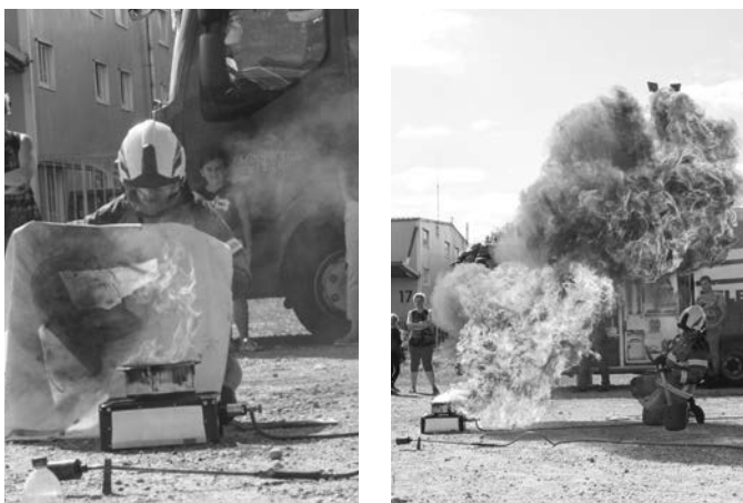
Löschen des Ölbrandes mit einer Löschdecke (links) oder mit Wasser (rechts).
